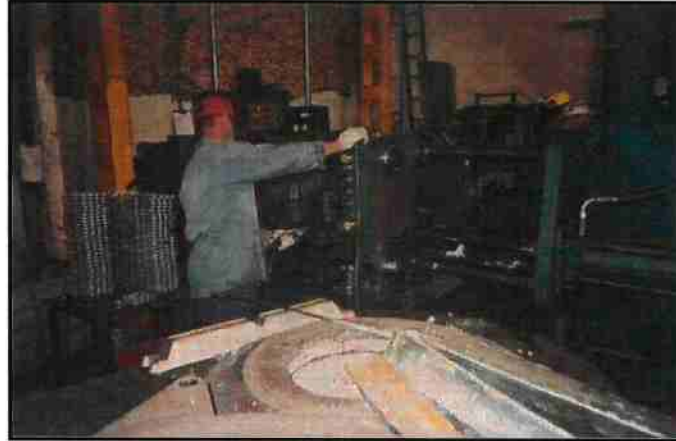
Figura 3. Procedimento de aplicação de desmoldante
