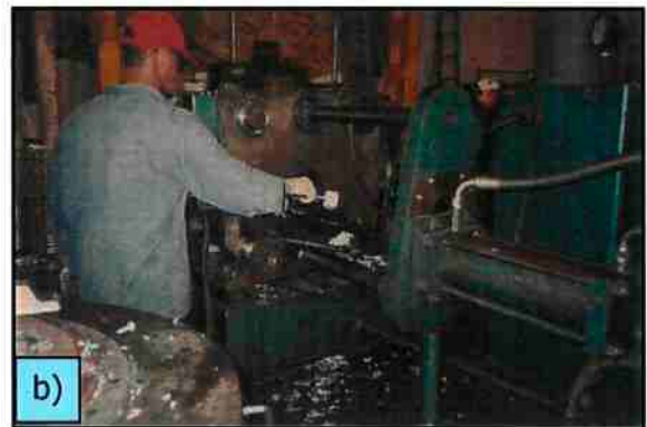
Figura 1. Procedimento de alimentação da máquina injetora com metal líquido
