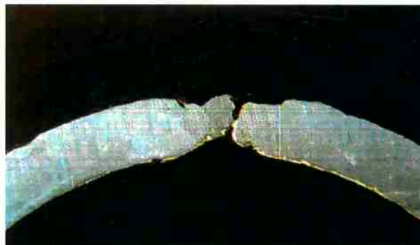
Figura 34. Análise dos defeitos ("β" cavidade N11), com auxílio de uma lupa a) Vista do defeito do modelo "β", cavidade N11 (aumento:10x) b) Vista do defeito do modelo "β", cavidade N11 (aumento:16x)
