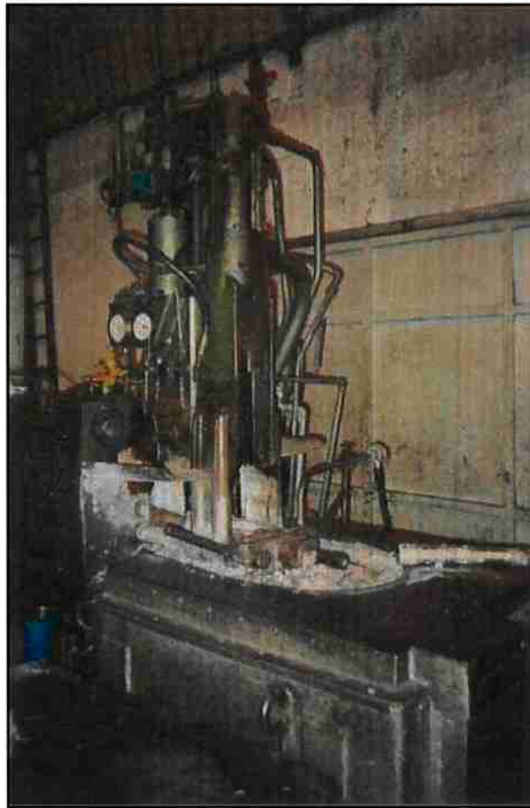
Figura 6. Sistema de injeção de uma máquina de câmara quente
