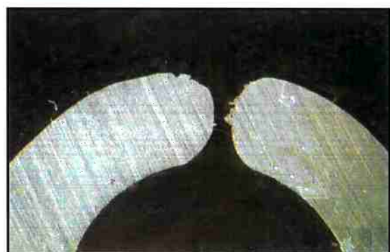
Figura 21. Análise dos defeitos ("α" cavidade N8), com auxílio de uma lupa a) Vista do defeito do modelo "α" (aumento: 10x) b) Vista do defeito do modelo "α" (aumento: 16x)
