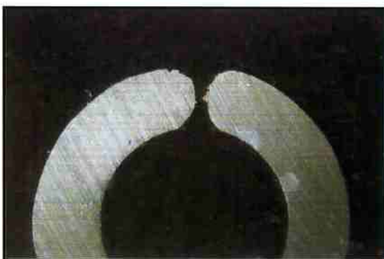
Figura 21. Análise dos defeitos ("α" cavidade N8), com auxílio de uma lupa a) Vista do defeito do modelo "α" (aumento: 10x) b) Vista do defeito do modelo "α" (aumento: 16x)
