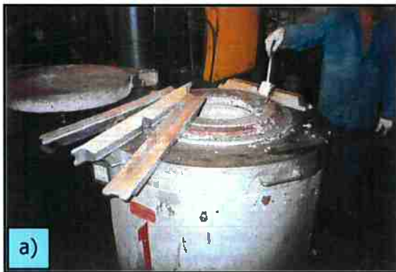
Figura 1. Procedimento de alimentação da máquina injetora com metal líquido
